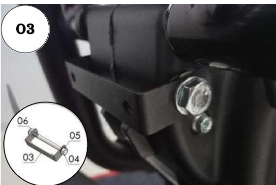
03 - Posicione o suporte frontal no local onde anteriormente foi removido o parafuso. Fixe utilizando o parafuso sextavado MA 10 - 1,50 X 120 AÇO 8.8 RP ZB, arruela lisa M10 e porca sextavada travante baixa com nylon - 1,50;
