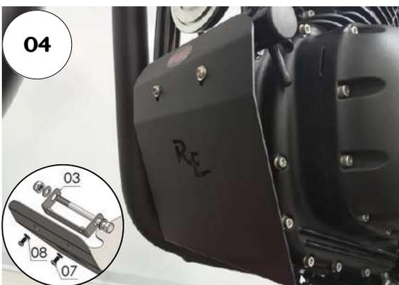
04 - Posicione a chapa do corpo principal do protetor de cárter conforme as furações de seu suporte, a logo "RE" deve ficar na parte frontal. Utilize para fixação os parafusos abaulados ALLEN MA 06 - 1,00 X 12 INOX RT e arruelas lisas 6,00 MM ZB;
