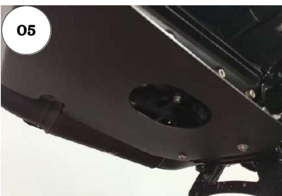
05 - Na parte inferior do protetor de cárter utilize também para fixação os parafusos abaulados ALLEN MA 06 - 1,00 X 12 INOX RT e arruelas lisas 6,00 MM ZB; Confira a posição de alinhamento e dê os apertos finais em parafusos e porcas do conjunto.
