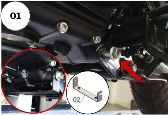
01 - Identifique o ponto de fixação na moto do suporte inferior do protetor de cárter. Não é necessário a remoção do parafuso, realize o encaixe no mesmo e na outra extremidade utilize os componentes originais;
