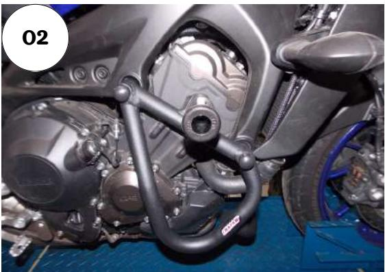
02 - Posicione a lateral direita do protetor conforme os pontos de apoio anteriormente citado;
