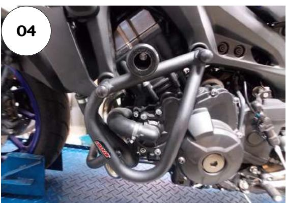
04 - Posicione a lateral direita do protetor conforme os pontos de apoio anteriormente citado;
