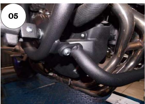
05 - Posicione o reforço central e fixe utilizando utilizando os parafusos abaulados MA 08 – 1,25 x 20 RT, arruela lisa M8 e porca sextavada trava baixa M8 – 1,25;
