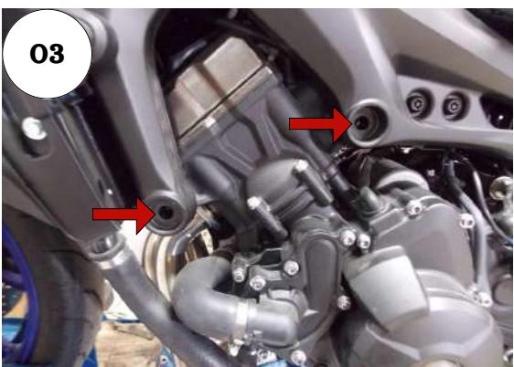
03 - Na lateral esquerda, retire os parafusos na qual fixam o motor no quadro;
