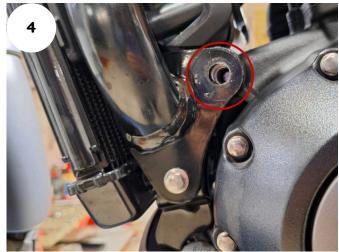
02 - Retire o parafuso frontal do motor, Fig. 03 e 04;
