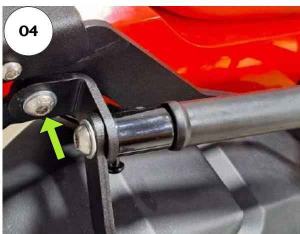
04 - Realize a união do bagageiro CHAPAM ao seu suporte, utilize o PARAF. CAB. ABAUL. ALLEN MA 08 - 1,25 X 20 INOX CL A2-070 para fixação;
