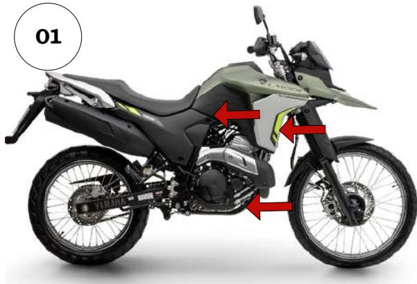
01 - Identifique os pontos de fixação do protetor dianteiro na moto;
