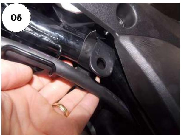
05 - Insira abraçadeira de fixação no quadro, localizado na curva superior (Abaixo do tanque) próximo ao parafuso superior das tampas laterais;
