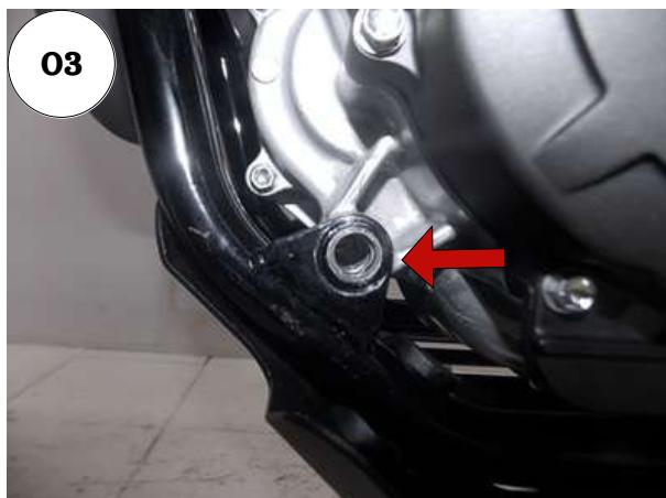
03 - Retire o parafuso que prende o motor, na parte inferior do quadro;
