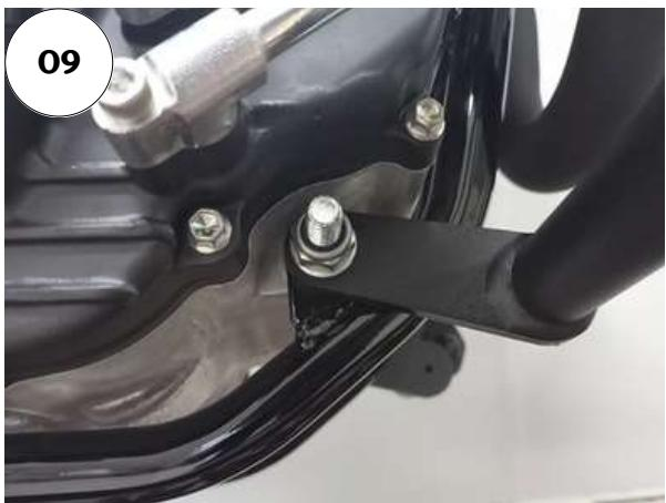
**09 - Na lateral direita, no parafuso anteriormente instalado, fixe o protetor direito utilizando ARRUELA LISA M10 (10,50 X 19,80 X 1,80MM) ZB e PORCA SEXT. TRAV. BAIXA MA 10 - 1,50;**
