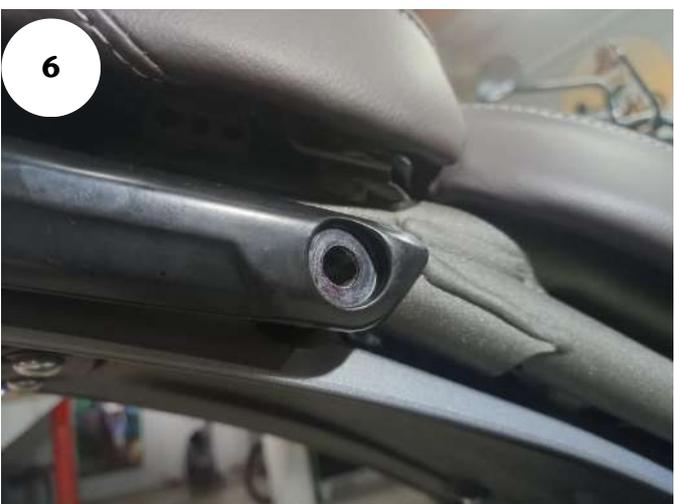
**03- Remova os parafusos de uma lateral da alça do passageiro, Fig. 05 e 06;**
