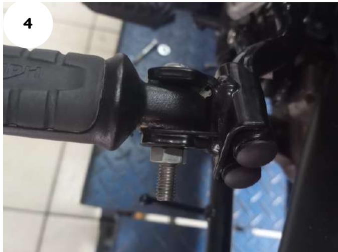
**02- Substitua o pino da pedaleira pelo Parafuso cab. abaulada MA 08 - 1,25 X 50 INOX rosca total, aperte a porca de modo que a pedaleira seja acionada, Fig. 03 e 04;**
