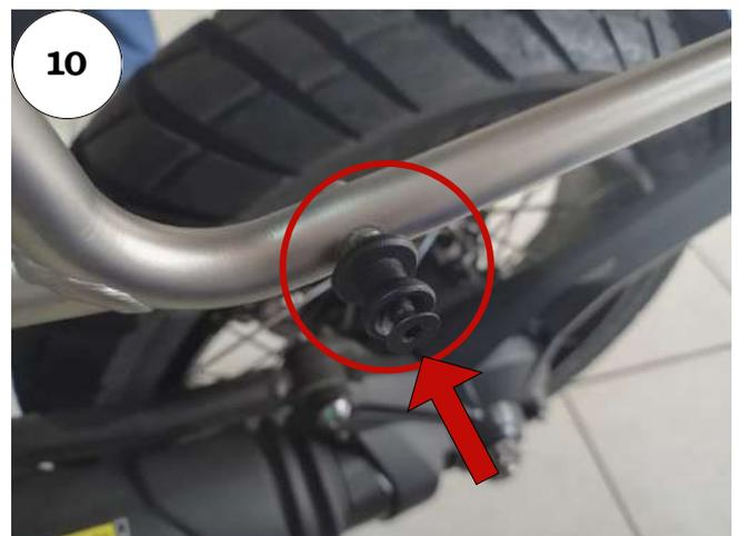
**05 - Na parte inferior do suporte de malas realize a troca dos carretéis originais pelos carretéis Chapam, fixe os mesmos utilizando os parafusos originais, Fig. 09 e 10;**
