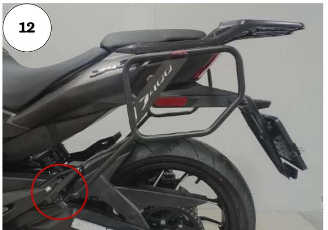
**07 - Depois de todos os itens instalado confira a posição e alinhamento dos mesmos, e dê o aperto final dos parafuso e porcas, Fig. 11;**
