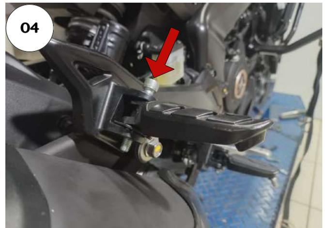
**01 - Faça a substituição dos pinos das pedaleiras do passageiro, pelo paraf. cab. cilind. ALLEN MA 08 - 1,25 X 55 INOX (rosca total), Fig. 03 e 04;**
