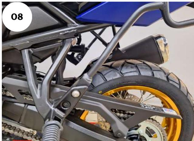
04 - Inicie a fixação do produto pelo parafuso inferior, utilize parafuso cab. abaulada ALLEN MA 08 - 1,25 X 20 INOX (rosca total), arruela lisa M8 (8,40 x 17,00 x 1,50 mm) e porca travante baixa M 8 X 1,25 ZB, Fig. 07 e 08;
