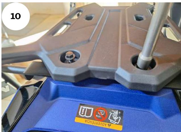
05 - Adicione a alça do passageiro original e a fixe acima ao suporte de malas laterais na moto utilizando os parafusos originais, Fig. 09 e 10;
