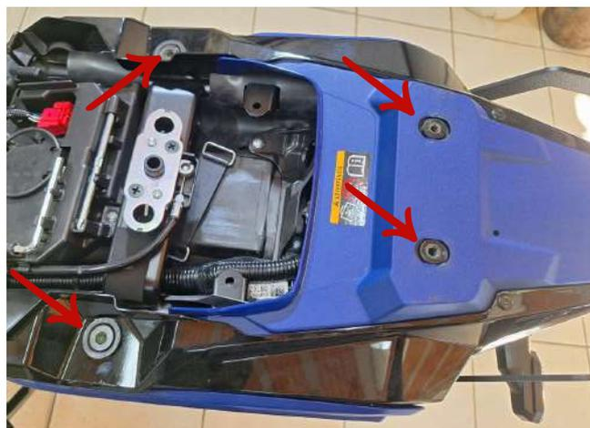
02 - Retire o banco da moto e os parafusos indicados acima, reserve-os pois serão utilizados na montagem, ao fim remova o bagageiro original , Fig.03 e 04;
