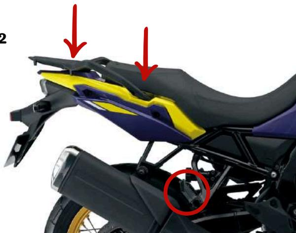
01- Identifique os pontos de fixação da peça, fig. 01 e 02;
