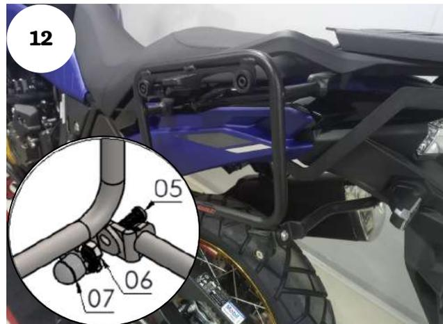
07 - Agora adicione o reforço central, utilize parafuso cab. abaulada ALLEN MA 08 - 1,25 X 20 INOX (rosca total) e porca travante baixa M 8 X 1,25 ZB para fixação, Fig. 11 e 12;
