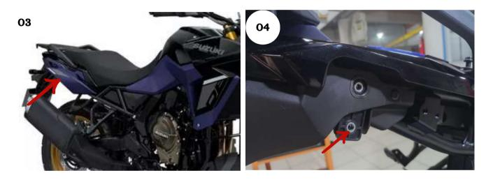
02 - Retire a carenagem lateral traseira, e encontre a furação inferior indicada, Fig. 03 e 04;
