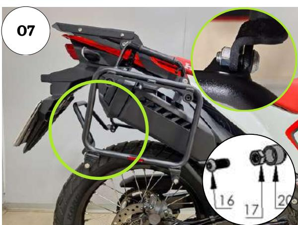
07 - Instale o reforço central, para fixação utilize o PARAF. CAB. ABAUL. ALLEN MA 08 - 1,25 X 40 INOX RI;
