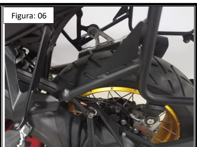
**03:** Fixar a haste inferior onde o mesmo deverá ficar posicionado atrás do suporte da pedaleira original do passageiro, utilize a arruela M6 e o parafuso 06 x 12 (itens 09 e 10), conforme detalhe C e Fig. 05 e 06;
