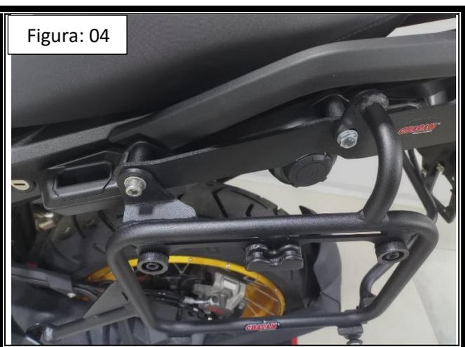
**02:** No segundo furo insira o espaçador de compr. 44 mm, arruela M8 e parafuso 08 x 110 (itens 07, 05 e 08), conforme detalhe B e Fig. 03 e 04;
