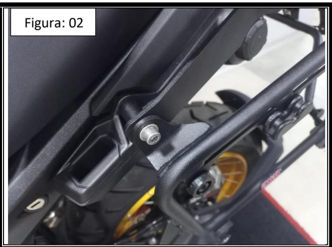
**01:** Identifique os parafusos a serem retirados (Fig. 01). No primeiro furo insira o espaçador de compr. 30,00 mm, arruela M8 e parafuso 08 x 80 (itens 04, 05 e 06), conforme detalhe A e Fig. 02.
