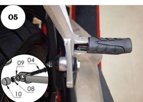
05 - Na parte inferior direita remova o parafuso original do apoio do escapamento, posicione a haste sobre o ponto de fixação e adicione parafuso abaulado ALLEN MA 08 - 1,25 X 60 INOX, arruela lisa M8 e porca sextavada travante baixa MA 8 - 1,25 ZB;
