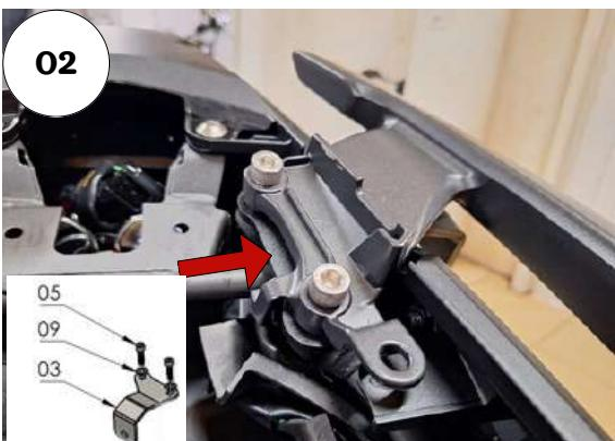
02 - Posicione o suporte entre os pontos de fixação e a alça original, utilize **parafusos cilíndricos ALLEN MA 08 - 1,25 X 30 INOX** e arruela lisa M8;
