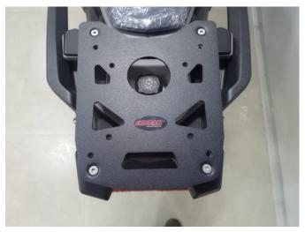
04- Posicione a chapa na posição correspondente as Fig 05 e 06, e adicione os (04)parafusos cabeça chata ALLEN MA 06 - 1,00 X 45 inox para unir o conjunto.
