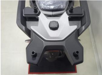
03- Posicione os espaçadores na localidade onde foram extraídos os parafusos, Fig 03 e 04;
