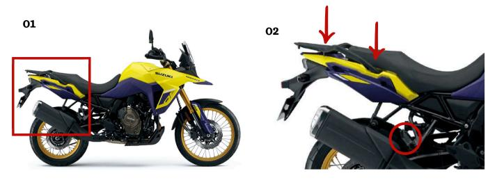
01- Identifique os pontos de fixação da peça, fig. 01 e 02;
