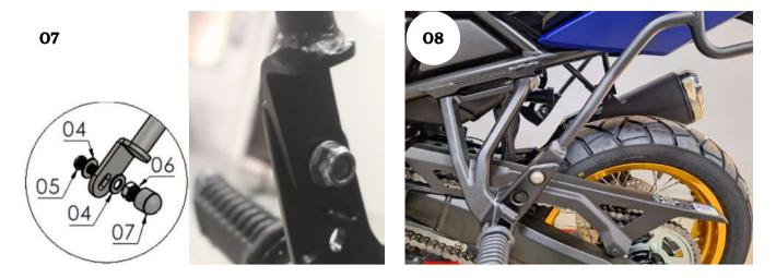
04 - Inicie a fixação do produto pelo parafuso inferior, utilize parafuso cab. abaulada, arruelas e porca travante, Fig. 07 e 08;
