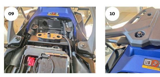
05 - Adicione a alça do passageiro original e a fixe acima ao afastador de alforge na moto utilizando os parafusos originais, Fig. 09 e 10;
