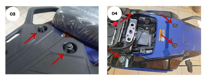
02 - Retire o banco da moto e os parafusos indicados acima, reserve-os pois serão utilizados na montagem, ao fim remova o bagageiro original, Fig.03 e 04;
