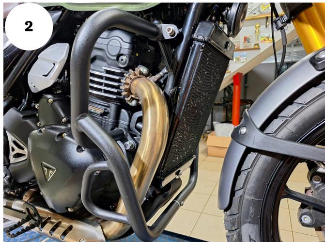
**01- Demonstração após a remoção do protetor de radiador original, Fig. 01 e 02;**
