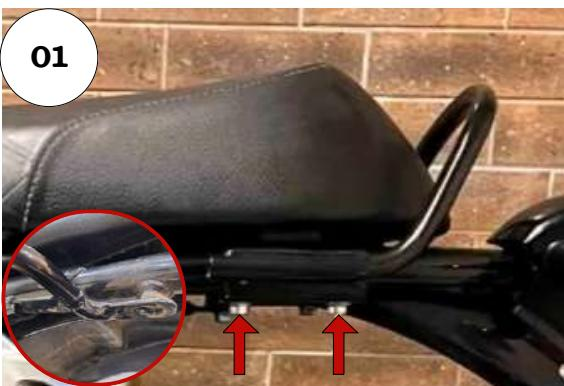
01 - Remova os parafusos indicados localizados na traseira da moto na lateral esquerda;
