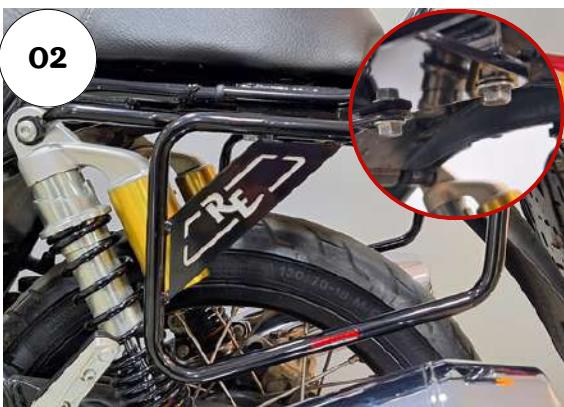
02 - Posicione a lateral correspondente do afastador de alforge entre a moto e a alça, fixe utilizando os componentes originais da moto;
